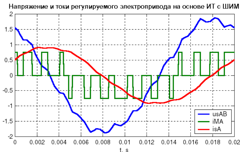
Рис. 2: u_{sAB} – одно из линейных напряжений статора, i_{MA} – один из выходных токов ПЧ, i_{sA} – один из линейных токов статора
